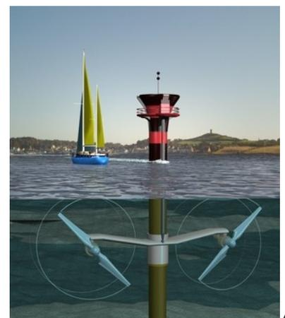
pâles remontent et s'immobilisent horizontalement au dessus de la surface de l'eau. Mesurant 16 mètres de diamètre, les rotors balayent un secteur de 402 mètres carrés. Les deux rotors développent une puissance 1200 kW (2x 600) et fonctionnent environ 20h par jour.
