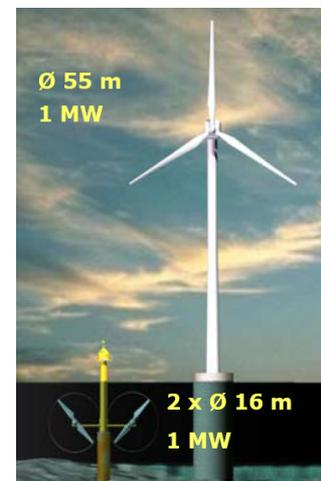
Figure 1 : Comparaison de la taille d'une éolienne et d'une hydrolienne de même puissance.
