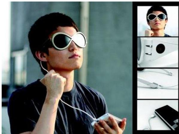
**Figure 17** : Chargeur d'appareil mobile fonctionnant à l'aide de cellules Grätzel, incorporées dans des lunettes
